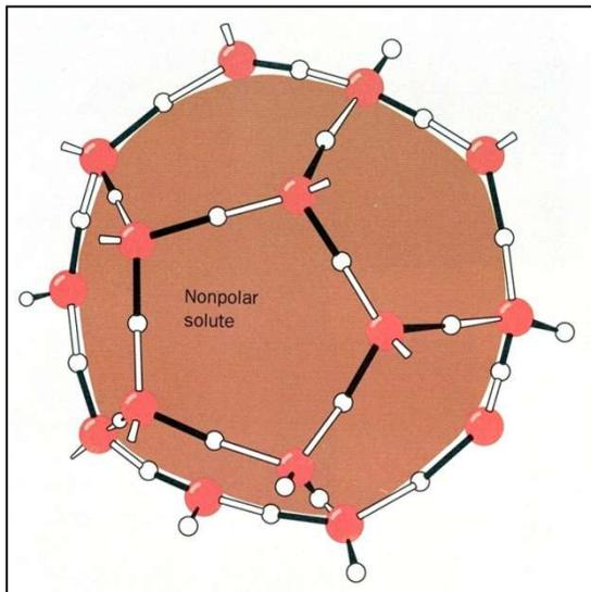
Estrutura ordenada da água em torno de um soluto não polar. As moléculas de água organizam-se de modo a maximizar o número de ligações de hidrogénio.
