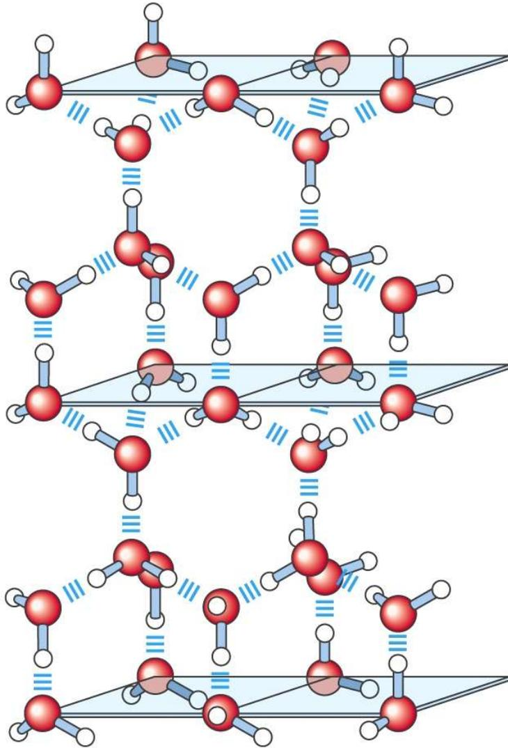
Estrutura do gelo. Cada molécula de água estabelece ligações de hidrogénio com 4 moléculas circundantes. O colapso deste retículo tetraédrico explica a diminuição de volume associado à fusão do gelo.
